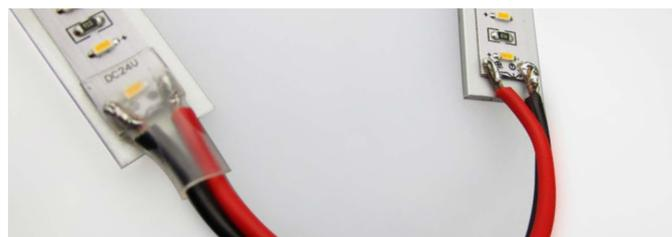
Abb. 3 Isolierung der Lötstellen: idealerweise mit einem Schrumpfschlauch
