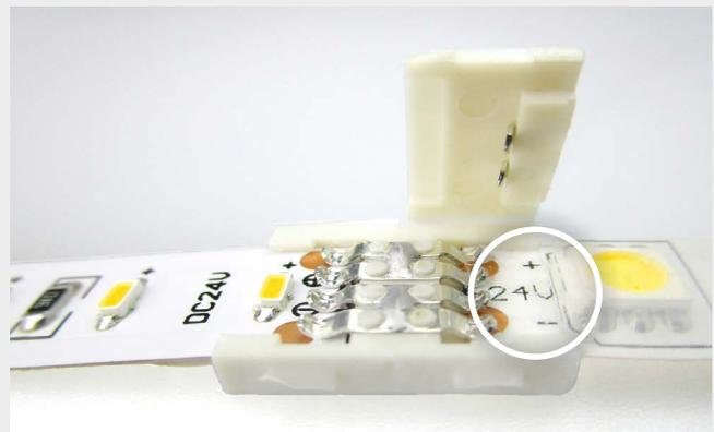
**Tip:** Bei einigen LED Flexbändern liegt der erste LED Chip sehr nahe an der Kontaktstelle. Zum richtigen und sicheren Verbinden muss einseitig die Verschlusskappe vom Clip-Verbinder entfernt werden. Links im Bild sieht man die entfernte Abdeckung!
