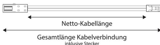
Die bei den einzelnen Artikeln angeführten Kabellängen beziehen sich immer auf das Maß der Netto-Kabellänge zwischen den Steckern. D. h. für die Gesamtlänge einer Kabelverbindung sind die Abmessungen der Stecker hinzuzufügen.
